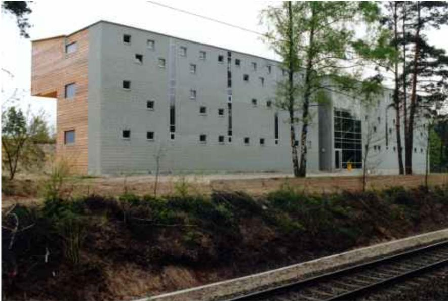
Abb. 5: Beispiel einer als Lärmschutz fungierenden Bebauung in Nürnberg (D) (Quelle: [www.heid-architekten.de](http://www.heid-architekten.de))
